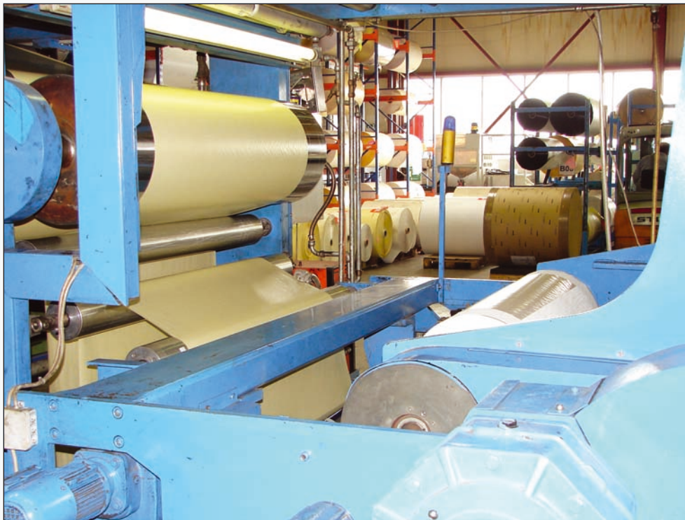
Kontinuierliche Messung der Kleberschicht mit Hilfe der Betacontrol-Sensortechnik
