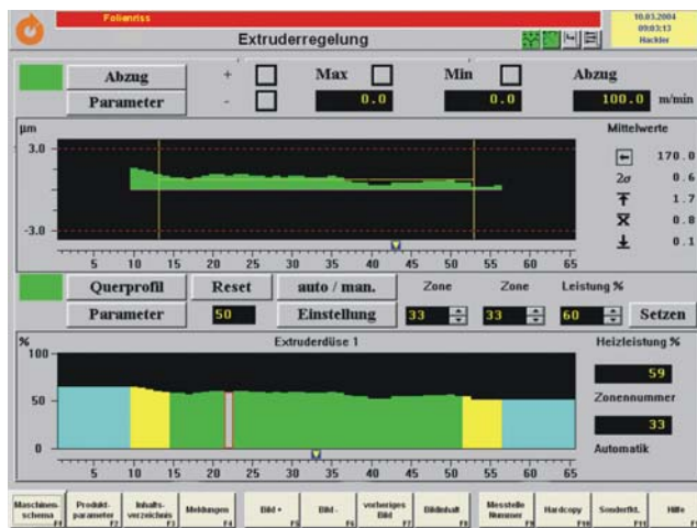
Parametrierung der Extruderregelung
