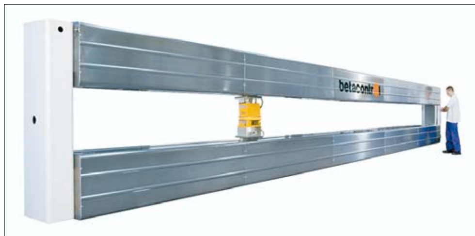
Eine der weltgrößten Traversen zur Qualitätskontrolle bei der Herstellung 10 Meter breiter BOPP-Folien
