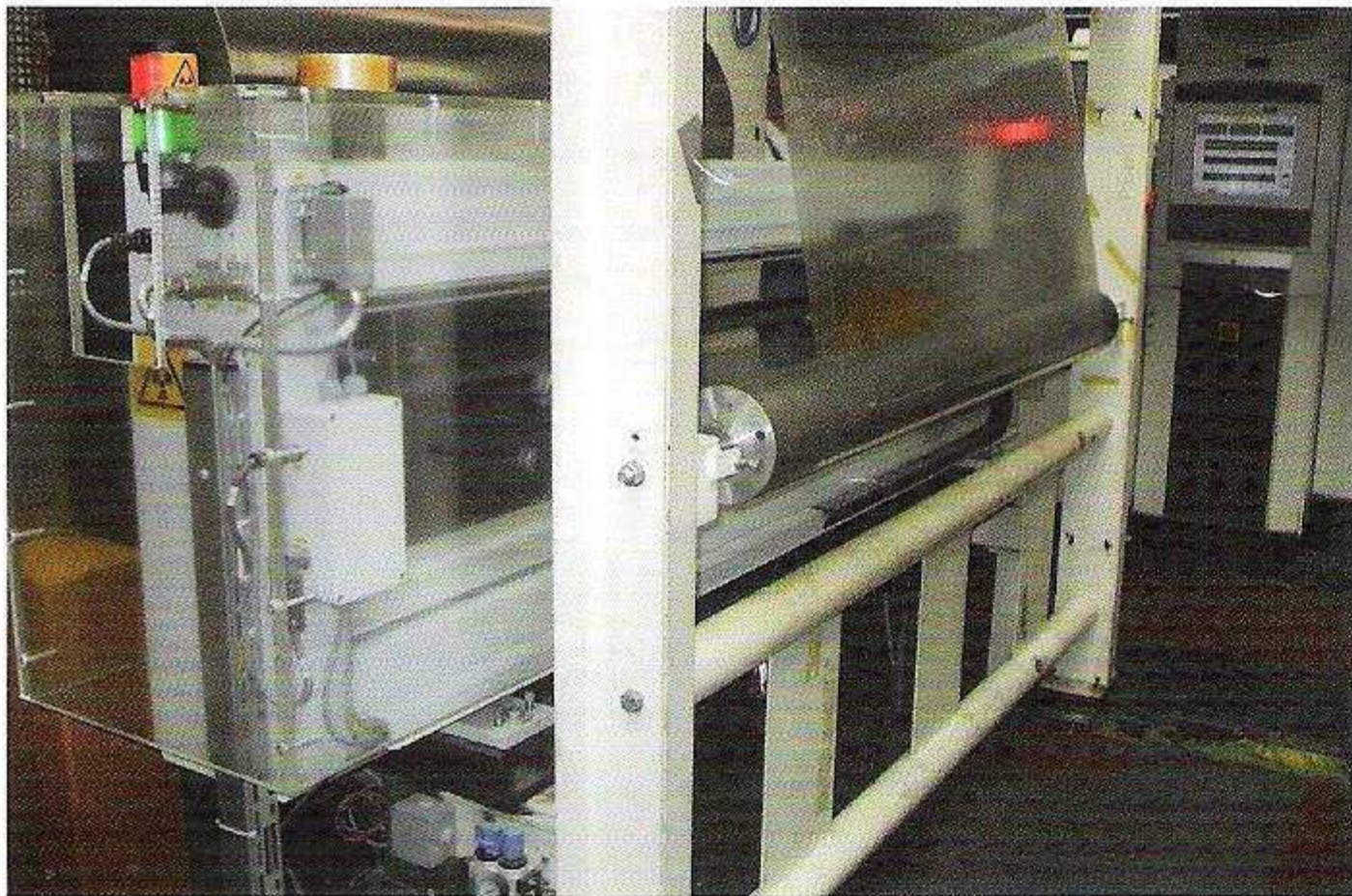
Abb.2: Radiometrische Sensoren messen das Flächengewicht der Folie
