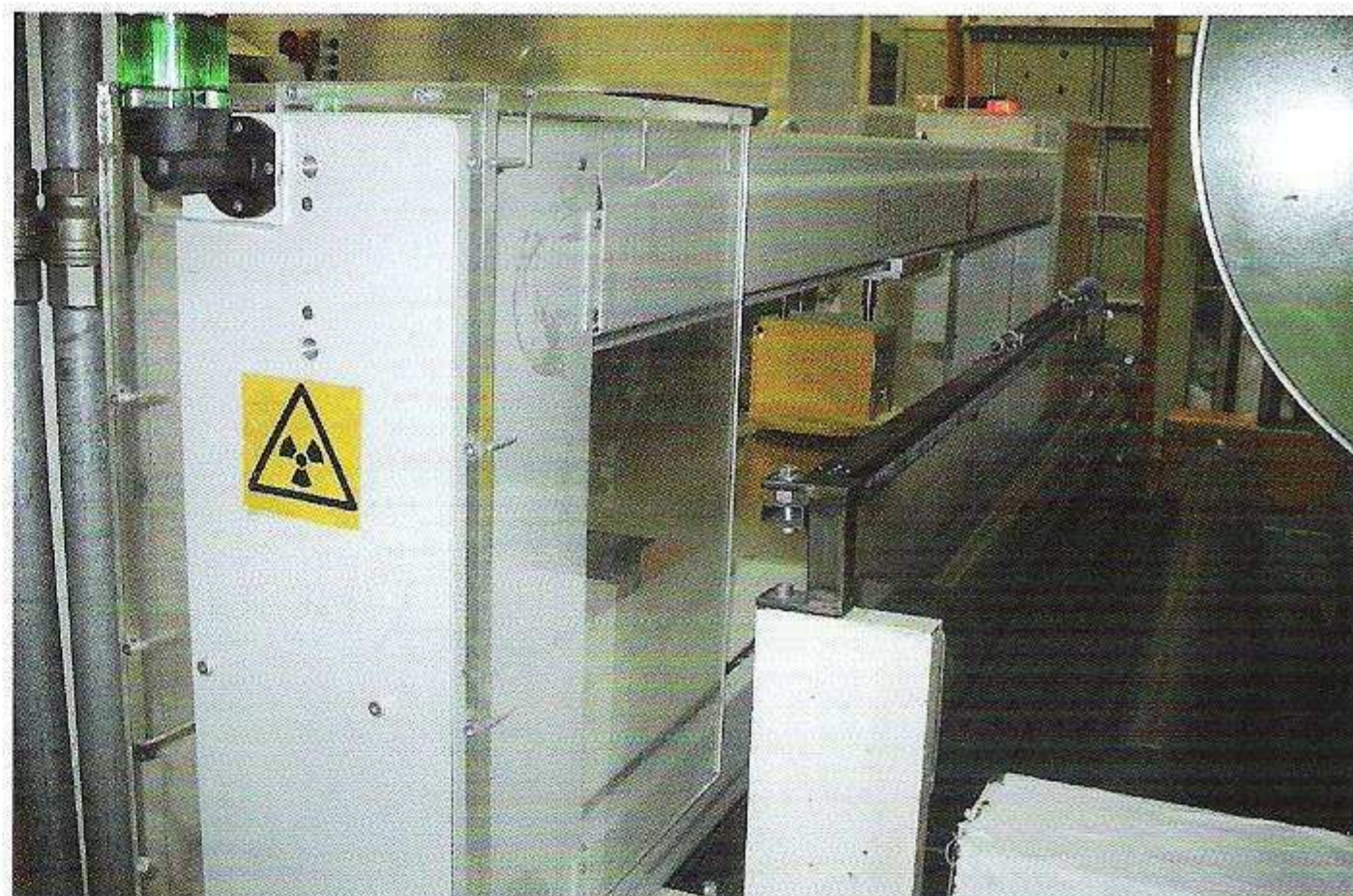
Abb.3: Neues Flächengewichtsmessgerät von betacontrol bei INEOS Films im Werk Staufen
